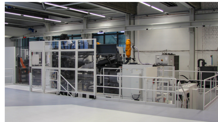
Auf der in Thannhausen neu installierten Spritzgussmaschine werden Werkzeuge direkt vor Ort bemustert und optimiert.
