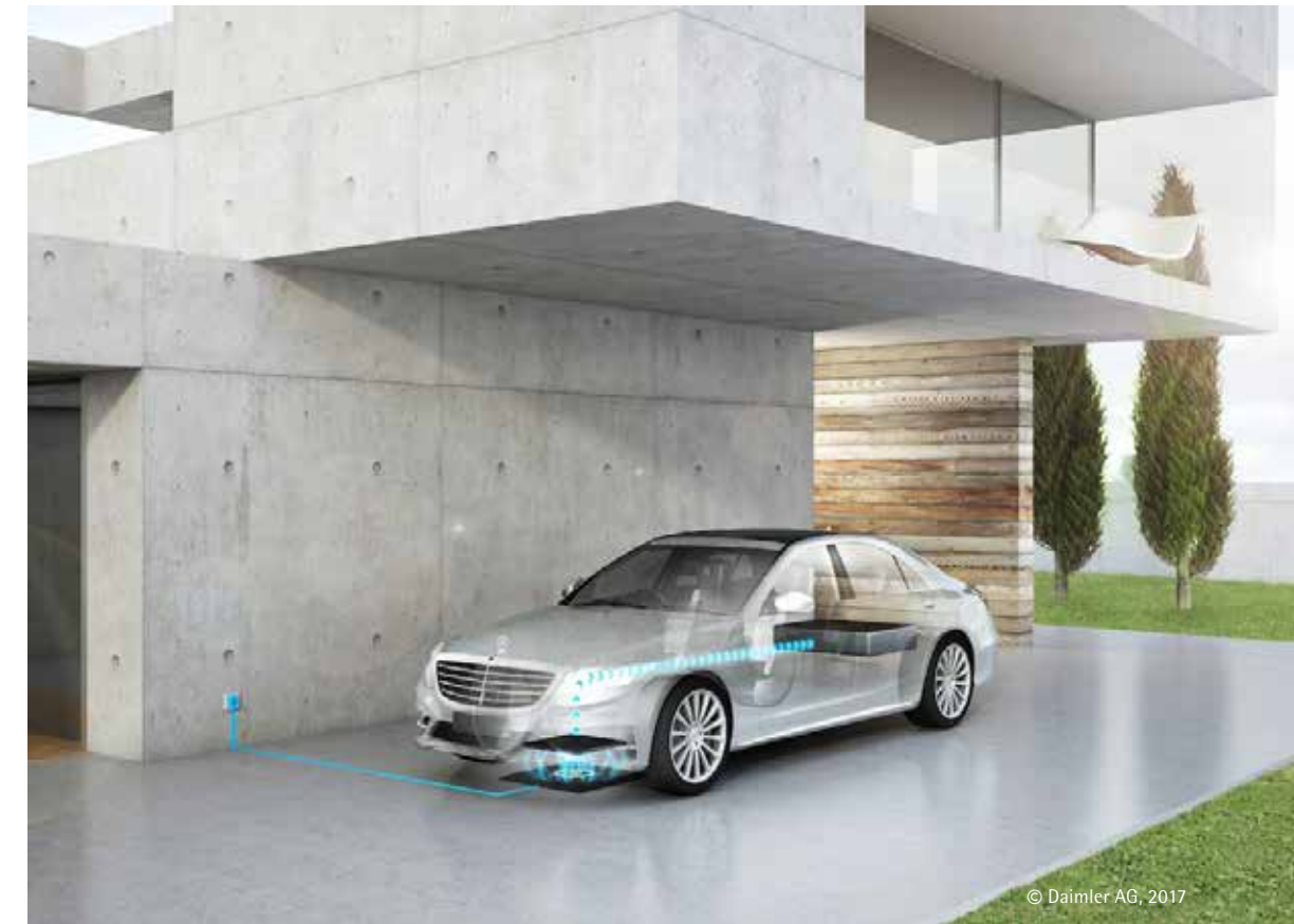
Kabelloses Laden: durch eine Sekundärspule im Fahrzeugboden sowie eine Bodenplatte mit integrierter Primärspule
