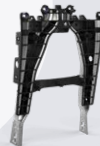
Hybridstrebe Funktionsintegriertes Strukturbauteil hinter der Instrumententafel
