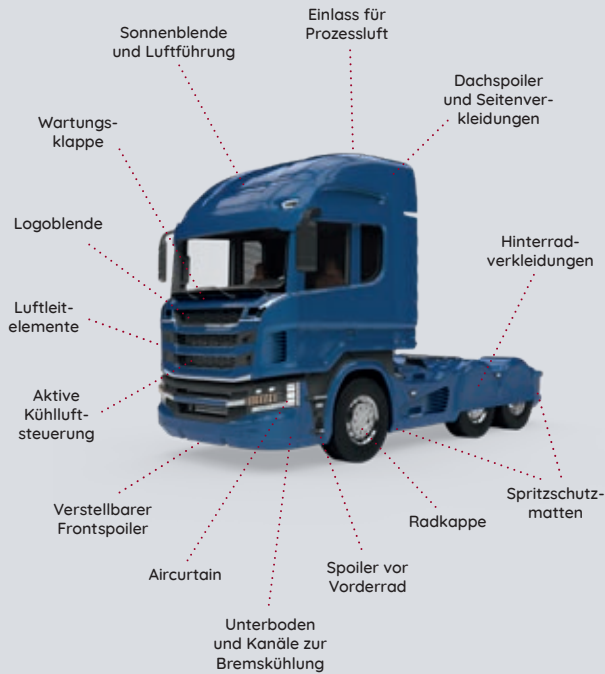
POLYTEC arbeitet an Lösungen, um die Aerodynamik von LKW zu verbessern.
