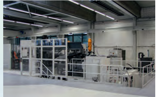
Auf der in Thannhausen neu installierten Spritzgussmaschine werden Werkzeuge direkt vor Ort bemustert und optimiert.
