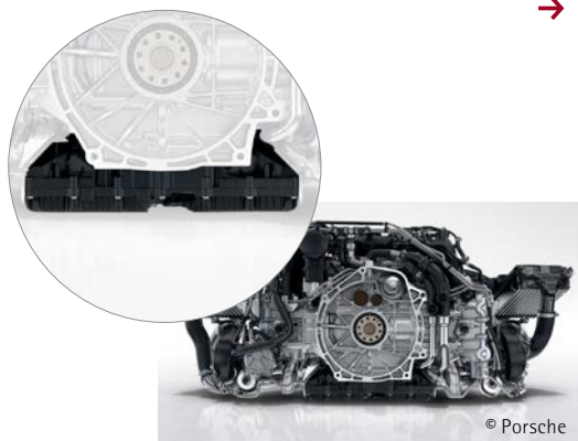
Die Produktentwickler von Porsche und POLYTEC mussten beim Entwurf der Ölwanne nicht zuletzt mit dem geringen Platzangebot unter dem Boxermotor des neuen Porsche 911 Carrera zurechtkommen.
