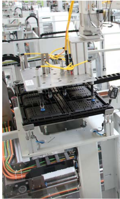
Nach dem Spritzgießen entnimmt ein Roboter die unterschiedlichen Teile der Mehrwegbox, bevor diese vollautomatisch zusammengebaut, mit einem individuellen Code etikettiert und bedruckt wird.
