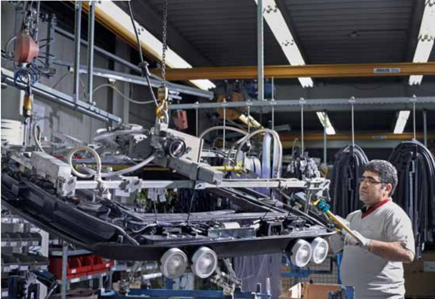
MONTAGE-MITARBEITER HACI B. bei der Assemblage eines John-Deere-Traktordaches im Composites-Werk in Gochsheim.
